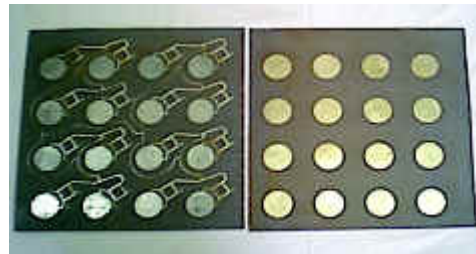
รูปที่ ๗ ตัวอย่างสายอากาศแบบระนาบที่แพร่กระจายคลื่นตามแนวกว้าง (ภาพนี้ได้รับความอนุเคราะห์จาก.....(ตัวอย่าง).....)
